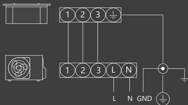
Электрическая схема (трехфазная)
