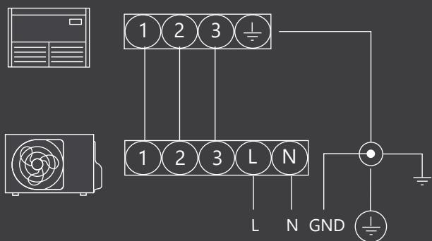
Электрическая схема (трехфазная)
