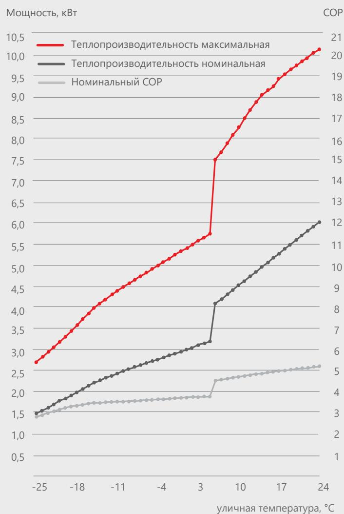
График зависимости теплопроизводительности от уличной температуры
