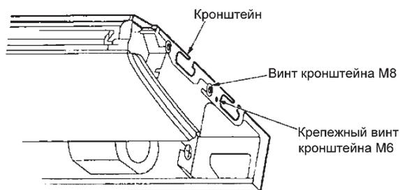
3. Монтаж шпильки кронштейна (используйте шпильки М10).
