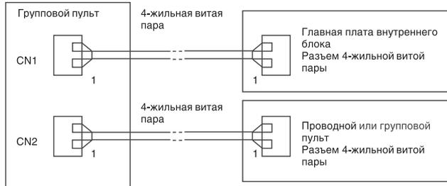
Перед монтажом и коммутацией убедитесь, что питание отключено. После выполнения монтажа и соединений проверьте результат работ, чтобы предотвратить неконтакт или короткое замыкание. В 4-жильной витой паре идут следующие сигналы: заземление (GND), линия связи A(A), линия связи B(B) и питание (+12 В).
