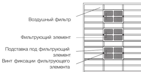
3. Выньте из упаковки сетчатый фильтрующий элемент, установите его на подставку и зафиксируйте.
