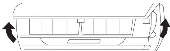
2. Очищайте панель мягкой щеткой, водой и нейтральным моющим средством, затем отряхните воду или высушите.
