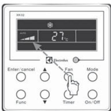
Во включенном/выключенном состоянии внутреннего блока нажимайте кнопку Вентилятор для изменения скорости вентилятора в следующей последовательности, изображенной на рисунке ниже.
