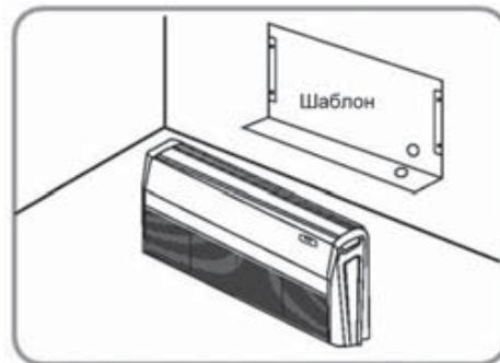
1. Определите положение монтажа на потолке или стене с помощью шаблона.
