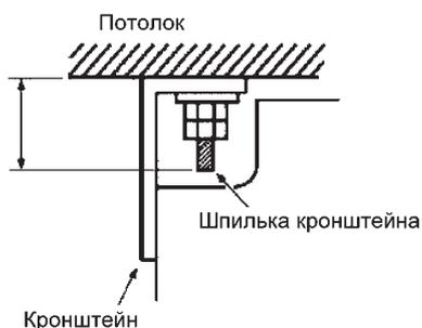
4. Зафиксируйте кронштейн на шпильке кронштейна.
