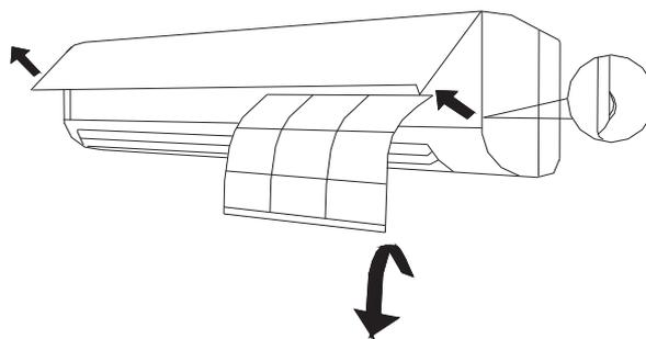
Вставьте опоры на концах панели в гнезда, медленно вращая панель. Закройте панель в направлении стрелок до щелчка.
