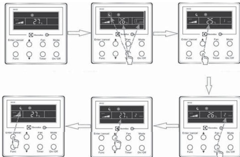
**Настройка регулировки температур в режиме сна 3**
