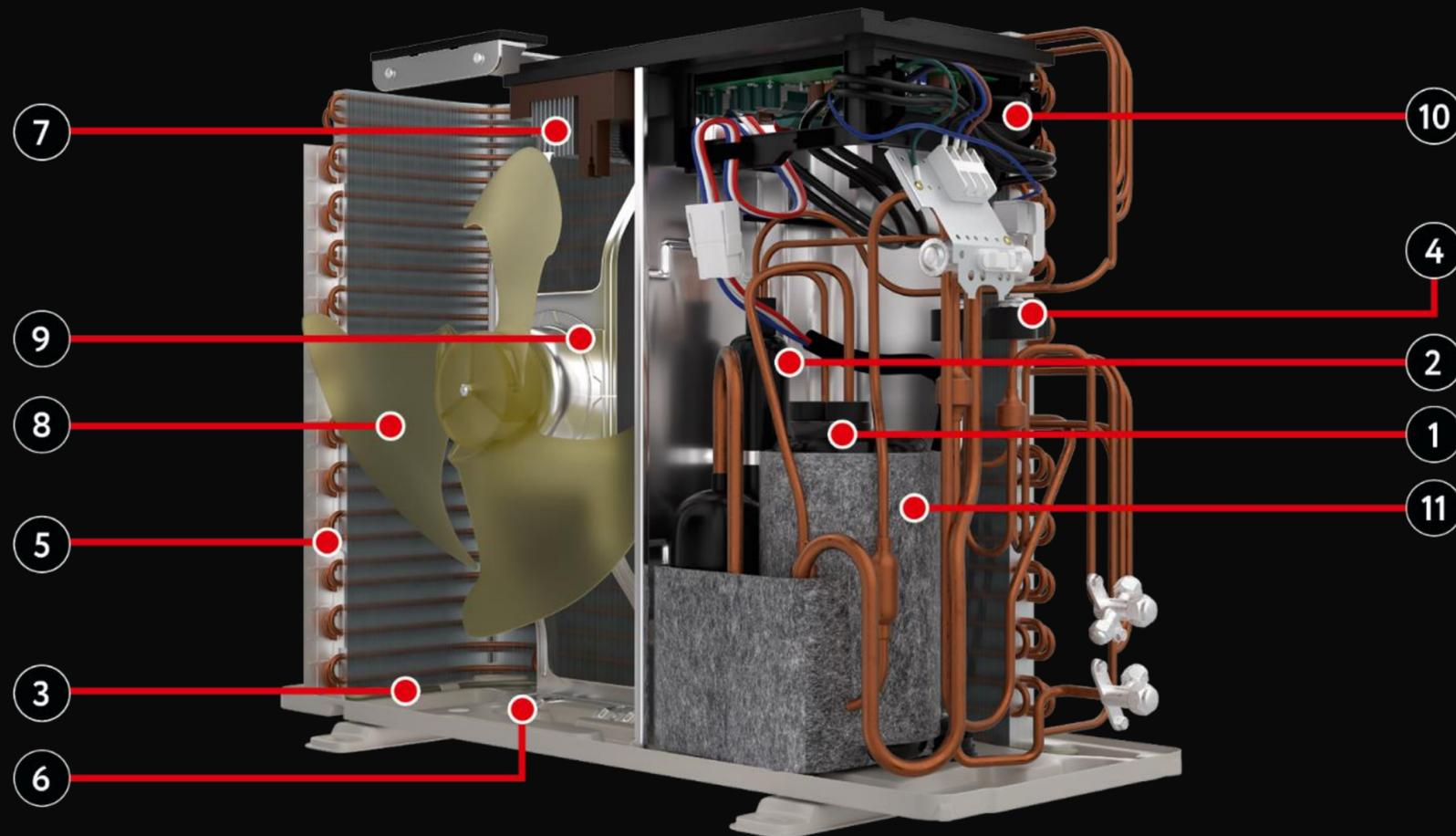
**1.** Премиальный 2-ступенчатый DC-inverter компрессор с технологией инжекции хладагента **SMART 2-Stage** и предпусковым подогревом **SMART Pre-Heat** для максимальной надежности и производительности
